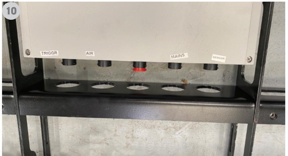
13. Montare il blocco elettrovalvole in posizione.
