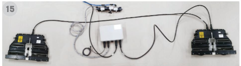
16. Posare l'alimentazione principale dell'aria al blocco elettrovalvole.
